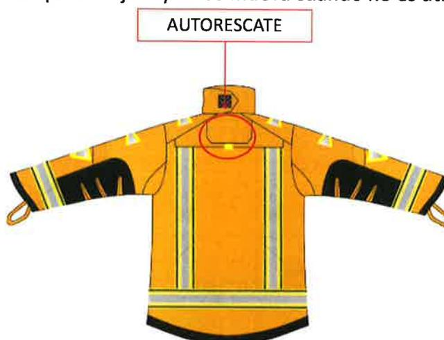
La cinta esta confeccionada con material ignifugo de alta resistencia y se ha construido en el interior de las capas del chaquetón de intervención, de forma que cuando se tira de ella se cierre alrededor de los hombros del bombero, de forma que permite remolcar el cuerpo del bombero de forma alineada con el eje de la columna vertebral.
